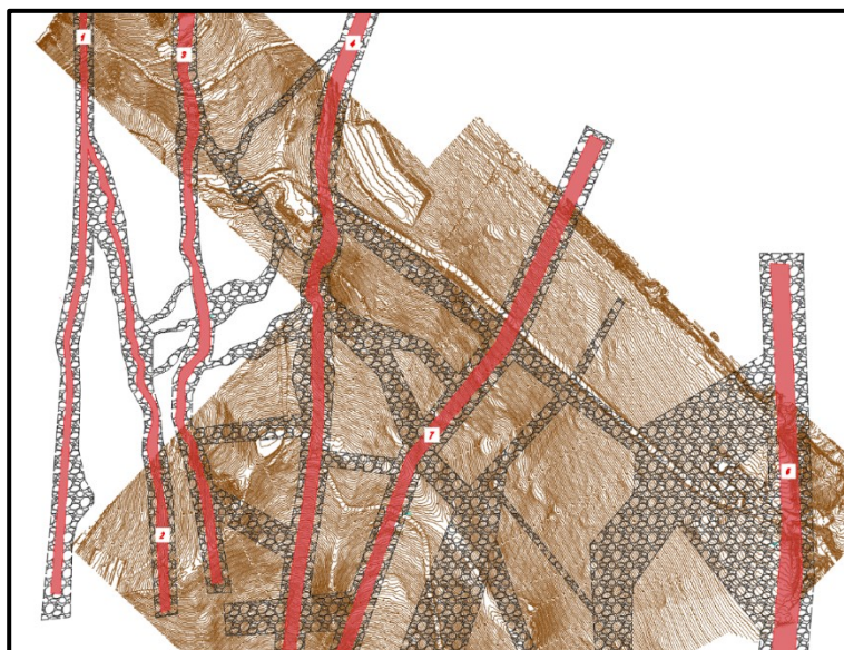
Рис. 7. Карта распространения зон активных тектонических разломов и тектонических дроблений. Масштаб 1:2500 (активные разломы выделены красным цветом, серой штриховкой выделены зоны дробления)
