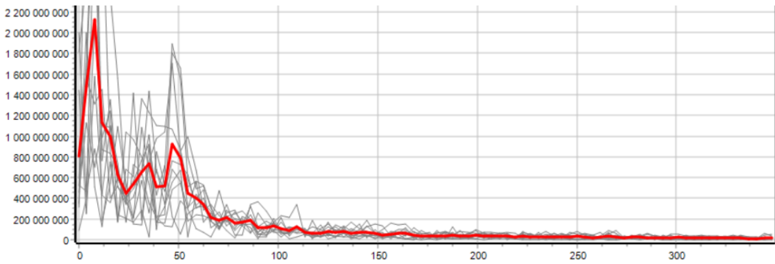
Рис. 9. Спектр зоны потери корреляции на глубинах 14-26 м сейсмограммы №1378
