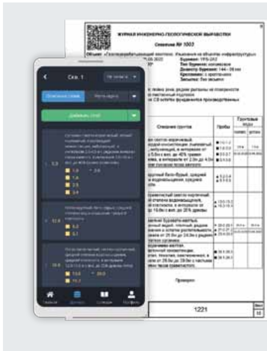
Рис 1. Образец автоматически заполненной таблицы по скважине с маркировкой для экспорта в облако общих данных
