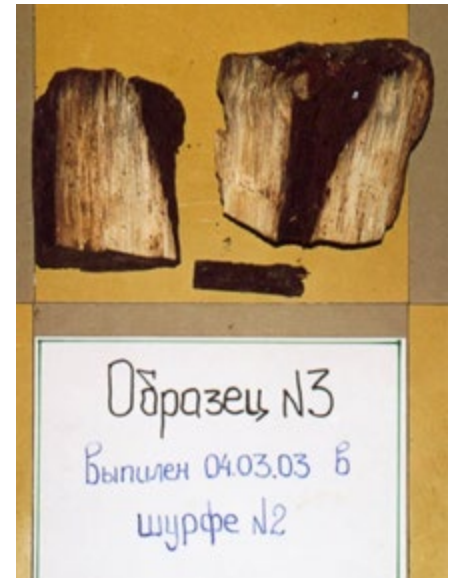
Рис. 6. Образец материала деревянной сваи из старого фундамента здания Главного штаба
