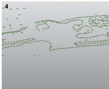
данные из формата IFC в базовые элементы: точка, линия, полилиния, дуга. В результате получаются данные (чертеж в формате DXF или список точек), готовые для передачи в прибор для выполнения разбивочных работ.
